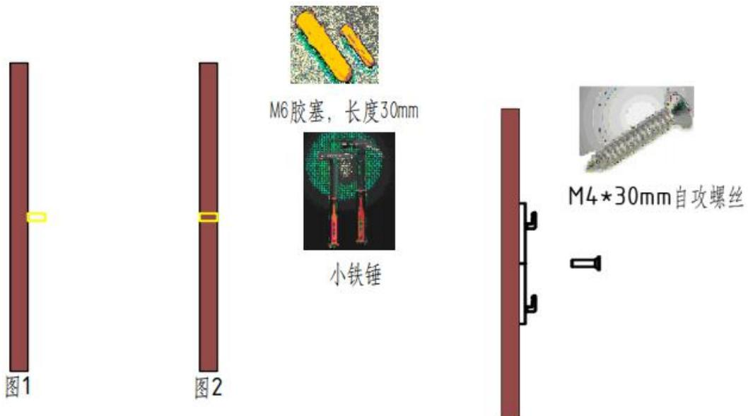
3. 把胶塞对准所钻取的两个 $\phi 6$ mm孔，在用锤子敲进去与墙面水平即可，如图1，图2所示。
