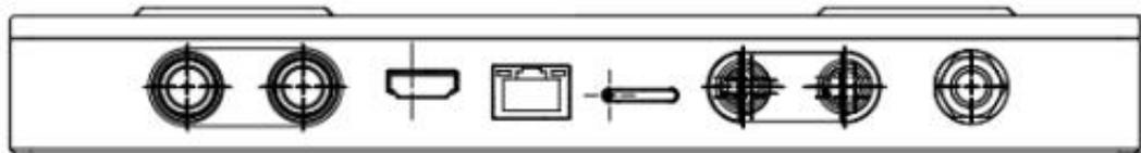
天线B 天线A HDMI 网口 SIM卡 通信插孔 供电插孔 电源开关
