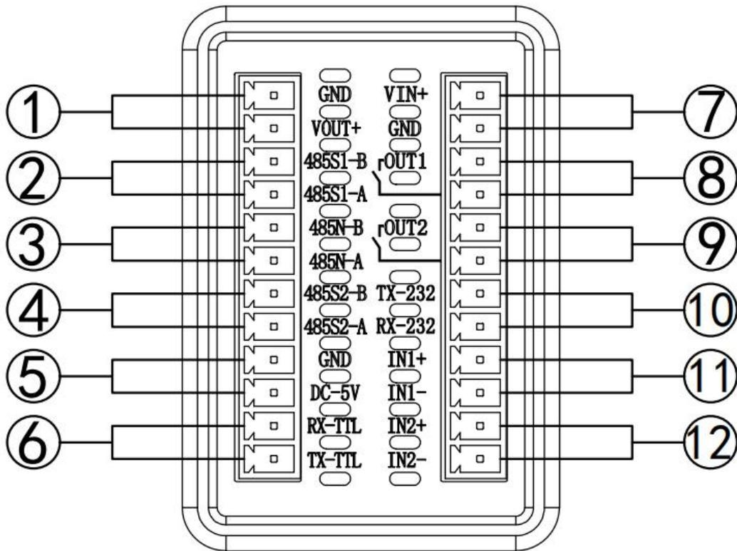
1.VOUT+、GND，对外供电输出接口，有外部供电时输出电压跟随仪表供电电压（VIN-0.3V），否则输出为 12V 电压，500mA；
