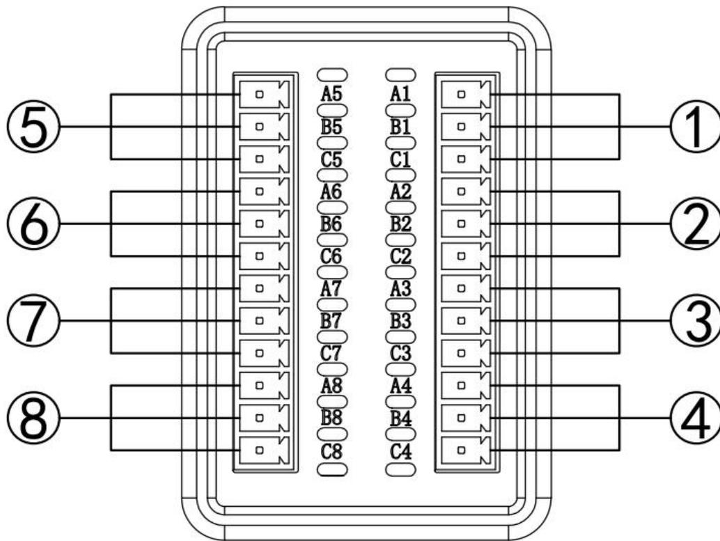
1-8 代表八个通道,A、B、C 代表一个通道的三个接线端子，为多功能采集输入端。
