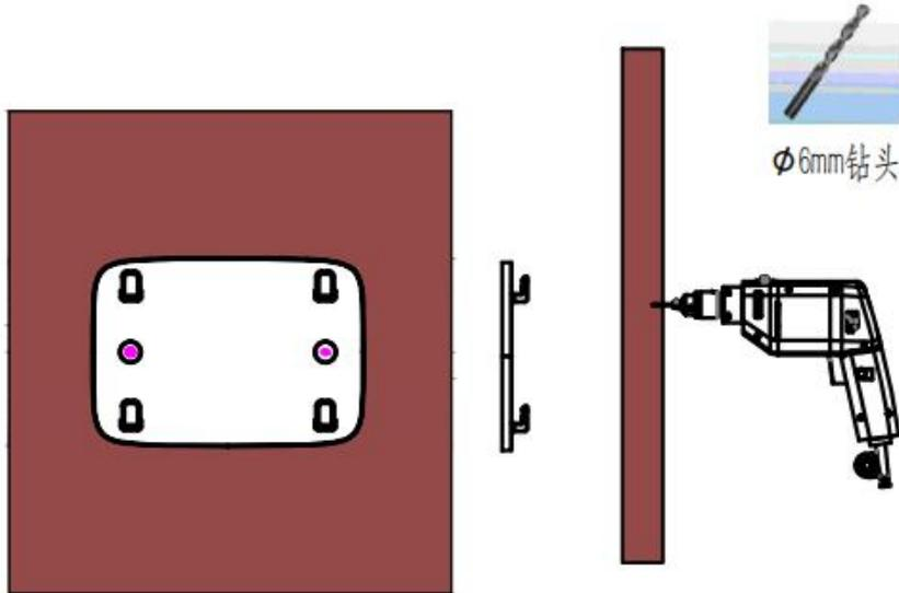
1. 将安装板放在安装位置并用水平仪测量水平度，然后使用标记器标记孔位置。
